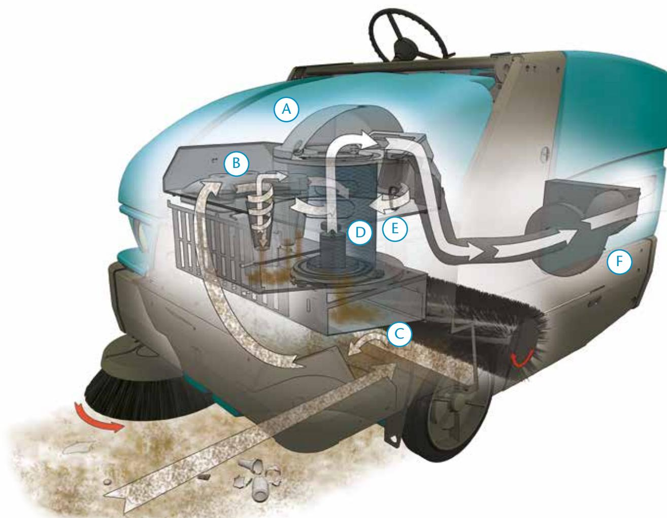
**A** **Compartimiento del operario.** Garantiza la seguridad del operario avisando y cortando la entrada de aire en caso de recalentamiento de la tolva, gracias a su sensor Thermo-Sentry
